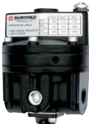
Пневматические объемные бустеры воспроизводят низкий поток управляющего сигнала в большой поток с настроенным выходным давлением. Бустеры используют не регулируемое входное давление для поддерживания настроенного выходного давления при наличии или отсутствии выходного потока.
