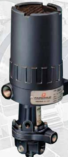
Один из ранних типов электро-пневматического управления - регулятор давления с мотором. Эта технология использует мотор для вращения винта регулятора давления. Заданное выходное давление настраивается с использованием AC, DC, или DC дискретных сигналов управления. Эти приборы прочны, надежны и обеспечивают подачу давления последней настройки при прекращении подачи питания.
