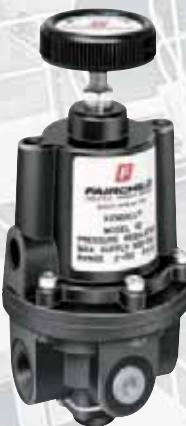
Пневматический регулятор уменьшает не регулируемое высокое входное давление в заданное низкое давление. Его главной функцией является поддержание заданного выходного давления при наличии или отсутствии потока воздуха.
